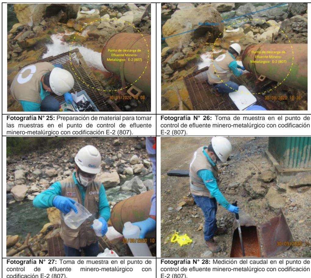
**Fotografía N° 25:** Preparación de material para tomar las muestras en el punto de control de efluente minero-metalúrgico con codificación E-2 (807).
